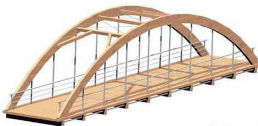
Slika 2.9 Konstrukcijski prikaz lučnog trozglobnog sustava (Izvor: Studija uređenja)
