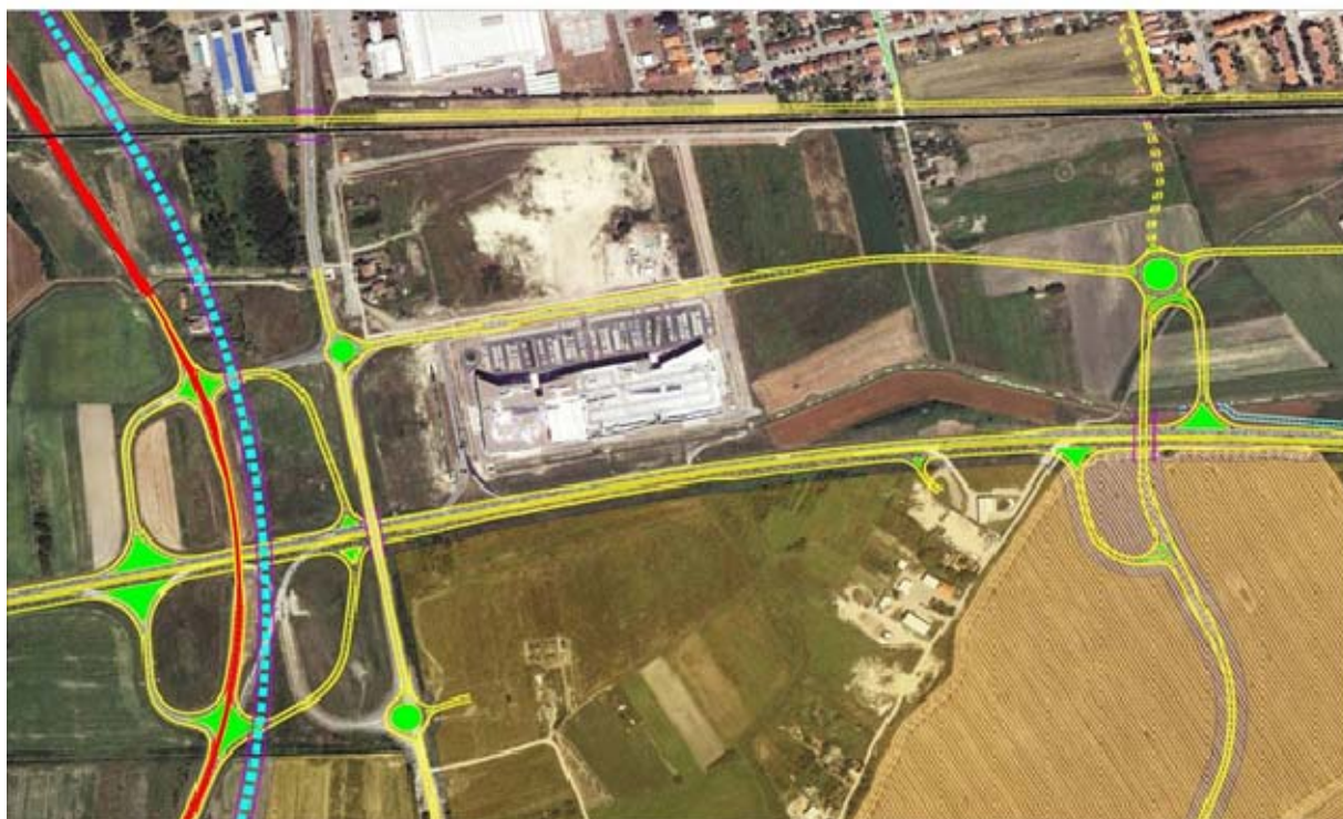
Slika 2 Prijedlog rekonstrukcije čvorišta "Frigis"
