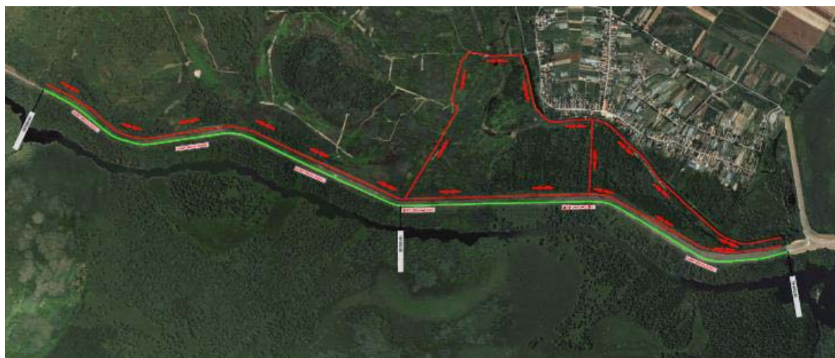
Slika 27. Shematski prikaz putova za transport materijala od pozajmišta do mjesta ugradnje (izvor podataka: građevinski projekt IDT d.o.o.)
