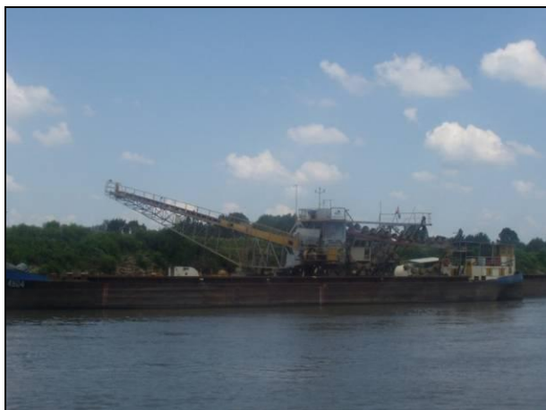
Slika 2-9 Istovarno vedričarsko (elevatorsko) postrojenje iz teglenice na obalu (moguć istovar i pod obalu) (foto: AVP).
