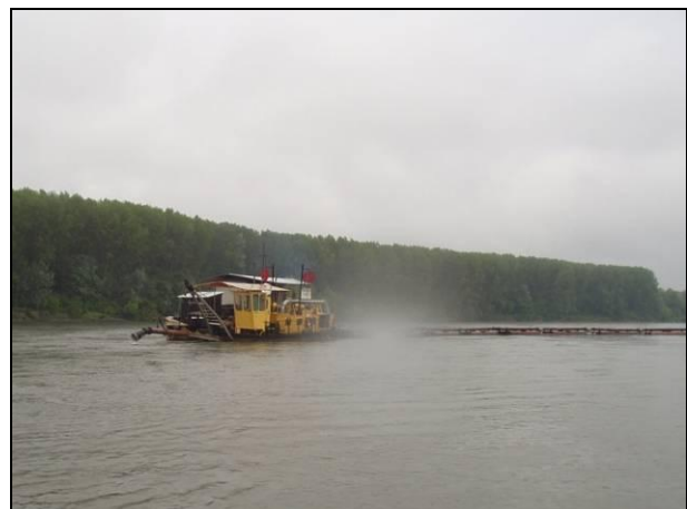
Slika 2-8 Stacionarni refulerni bager (foto: AVP).
