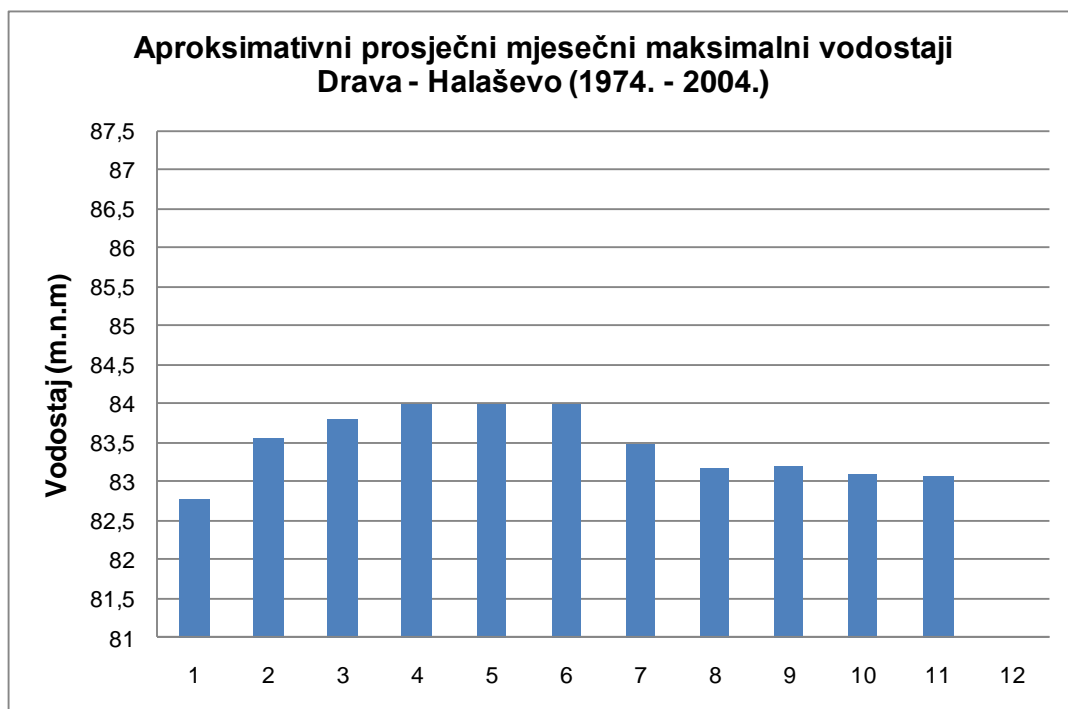
Slika 2.3.9: Aproksimativni prosječni mjesečni maksimalni vodostaji Drave uz rukavac Halaševo
