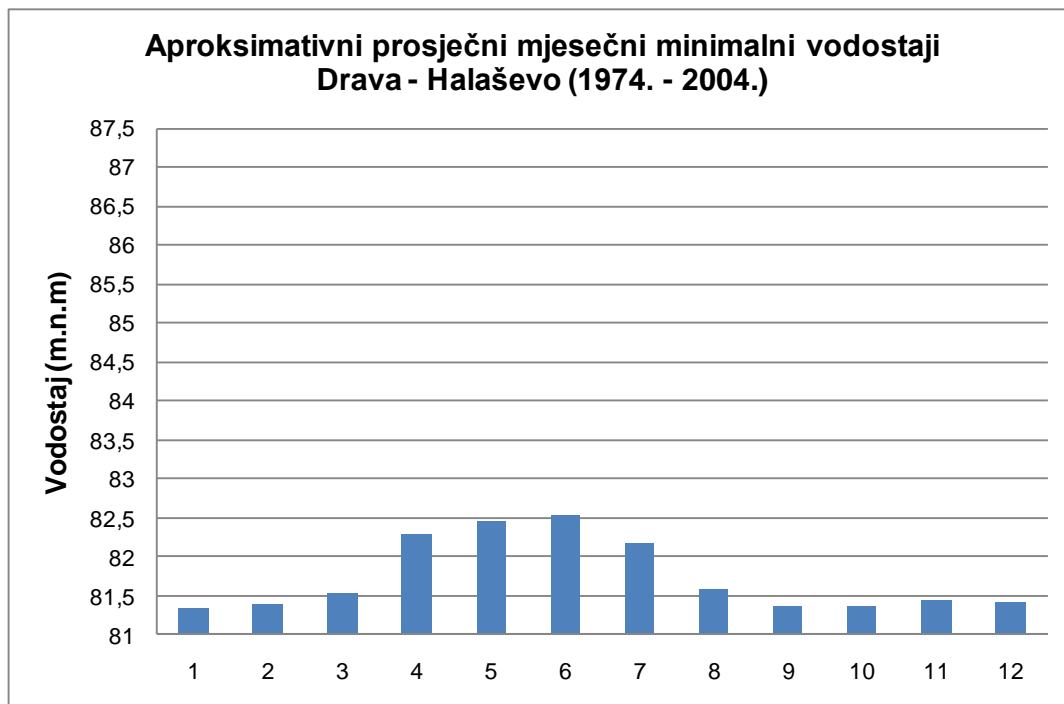
Slika 2.3.7: Aproksimativni prosječni mjesečni minimalni vodostaji Drave uz rukavac Halaševo
