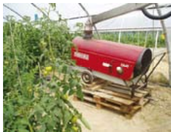
Slika 18: Prenosiva jedinica koja koristi i loživo ulje i plin (snimila Parađiković, N.)
