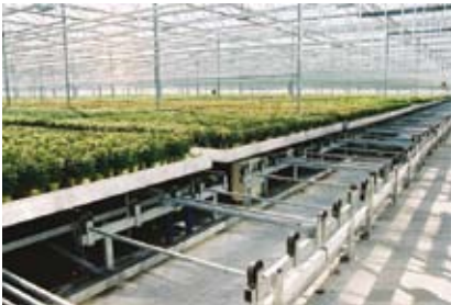
Slika 46 a i b: Pokretni stolovi (arhiva KG-Systems) i stabilni (snimila Parađiković, N.)
